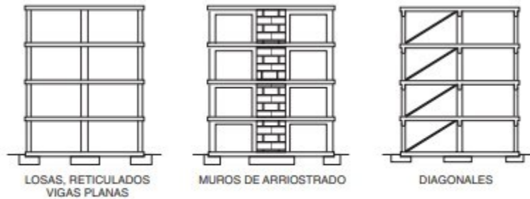
Figura 3.6. Ejemplos de organizaciones estructurales que permiten un valor del coeficiente de comportamiento por ductilidad \mu = 2
